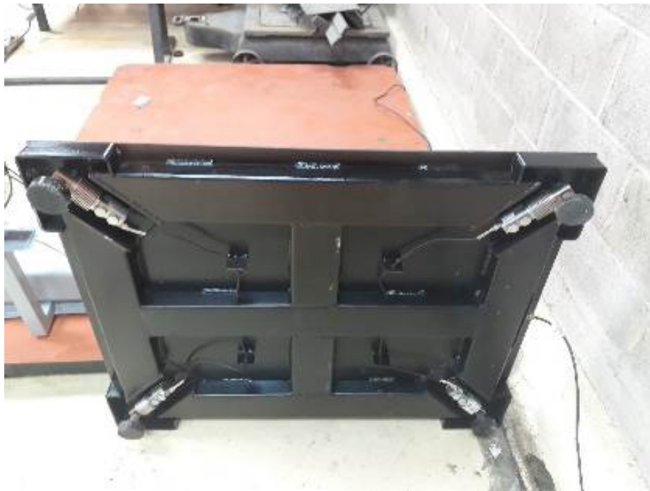
Figura 8: Parte inferior de la balanza de plataforma Fuente: Marin C. (2019)
