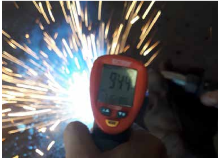
Figura 12: Temperatura menor de soldadura MIG Fuente: Marin C. (2019)
