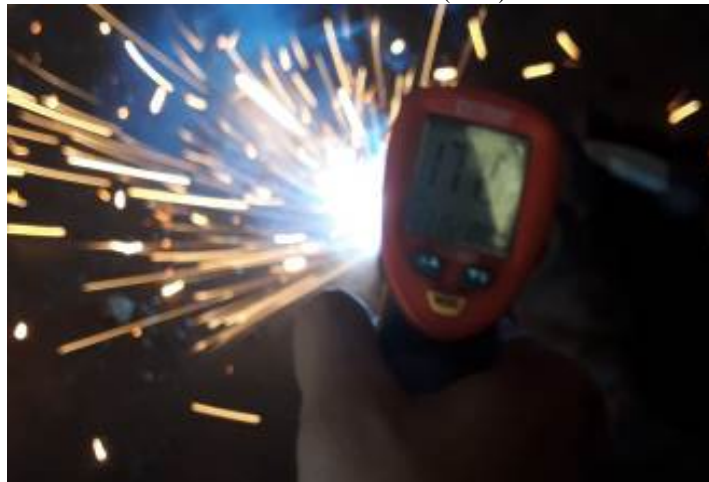
Figura 13: Temperatura mayor de soldadura MIG Fuente: Marin C. (2019)
