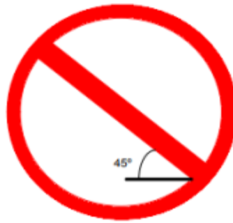
Figura 26. Señal de Prohibición Fuente: (Norma Venezolana, 2003)
