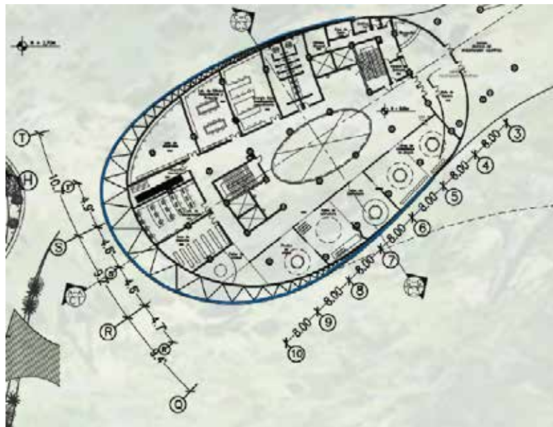
Canal de color azul para recolección de aguas pluviales.
