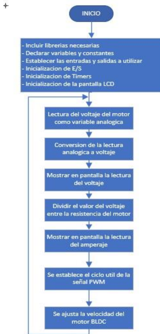
Figura 46: Diagrama de flujo del funcionamiento del código en Arduino. Fuente: Marcos Flores (2023).
