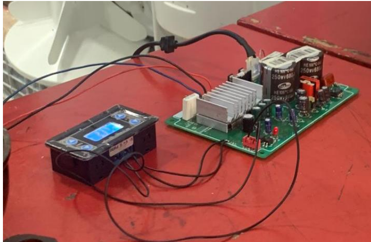
Figura 27: Tarjeta de prueba para motores sin tecnología inverter empleada por técnicos.
