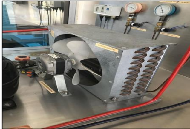
Figura 25: Modelo de Banco de prueba de sistemas inverter en refrigeración
