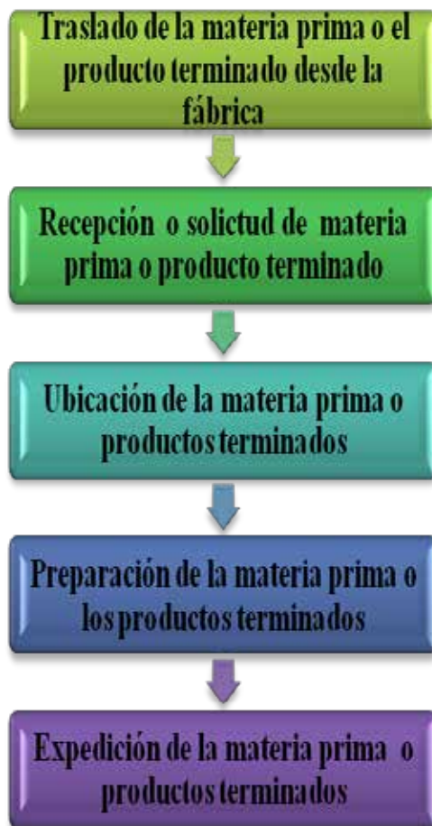
Figura 35. Diagrama de bloque de los procesos que se siguen en el almacén
