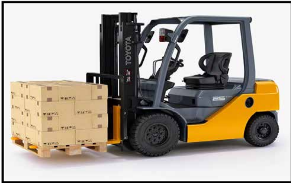
Figura 29. Montacargas para traslado de piezas metálicas de la planta al almacén
