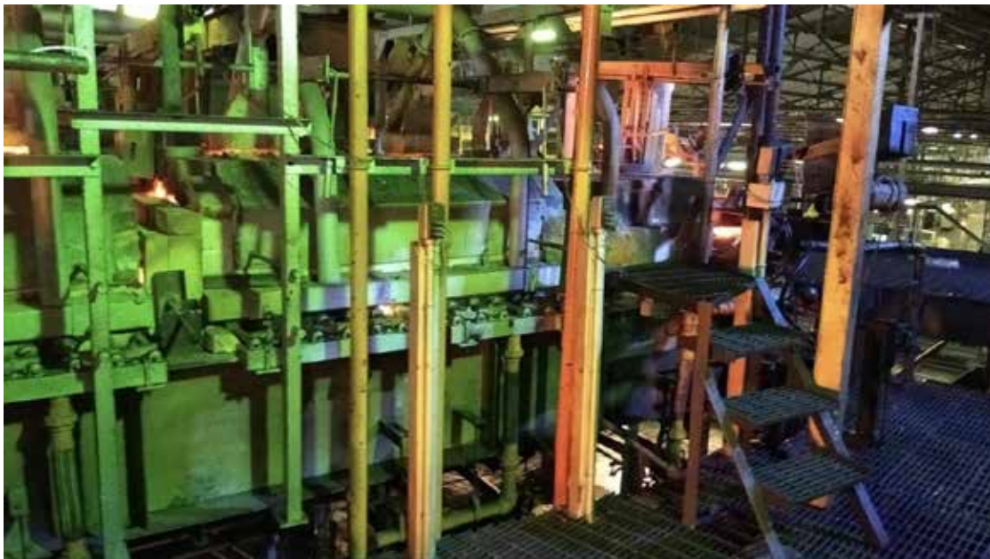
Figura 7. Máquinas y equipos (ALIMENTADOR) utilizados en el proceso productivo actual para la fabricación de la botella GK02006 en la línea de producción A-1. Fuente: Empresas Venezolana del Vidrio C.A. (2021)
