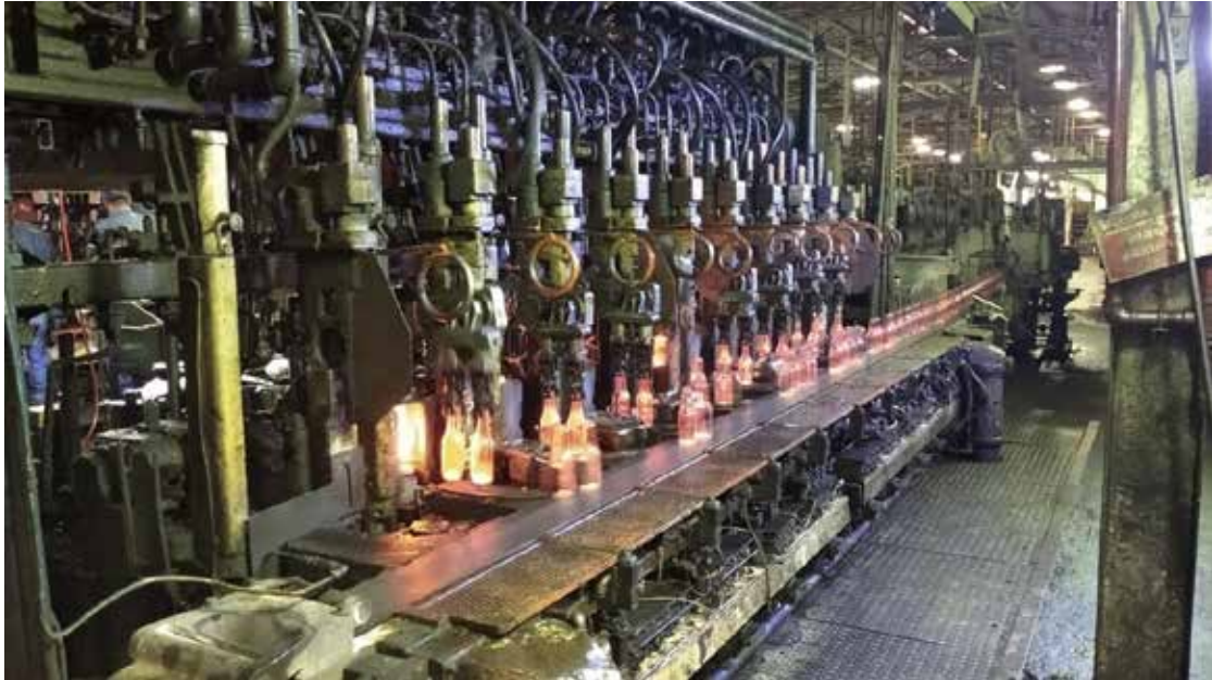
Figura 8. Máquinas y equipos (MÁQUINA IS) utilizados en el proceso productivo actual para la fabricación de la botella GK02006 en la línea de producción A-1. Fuente: Empresas Venezolana del Vidrio C.A. (2021)
