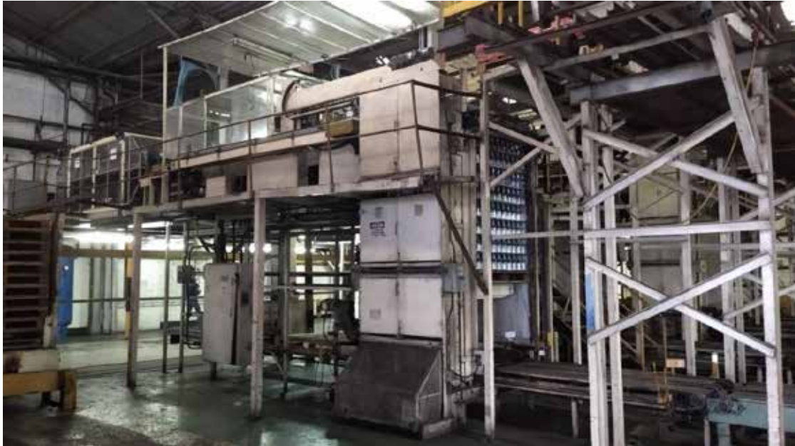
Figura 10. Máquinas y equipos (PALETIZADOR) utilizados en el proceso productivo actual para la fabricación de la botella GK02006 en la línea de producción A-1. Fuente: Empresas Venezolana del Vidrio C.A. (2021)
