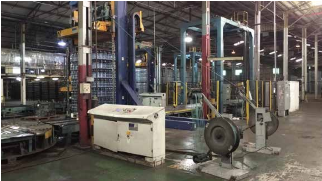
Figura 11. Máquinas y equipos (FLEJADORA) utilizados en el proceso productivo actual para la fabricación de la botella GK02006 en la línea de producción A-1. Fuente: Empresas Venezolana del Vidrio C.A. (2021)
