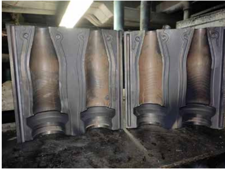
Figura 2. Moldes utilizados en el proceso productivo actual para la fabricación de la botella GK02006 en la línea de producción A-1.
