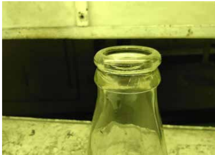
Figura 3. Botellas defectuosas GK02006 en la línea de producción A-1.
