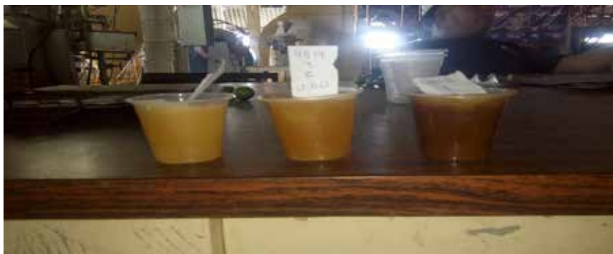
Figura 23: De Izq. a Der. Masas Cocidas de Refino A, B y C. Autora: Vaccari, I. 2021
