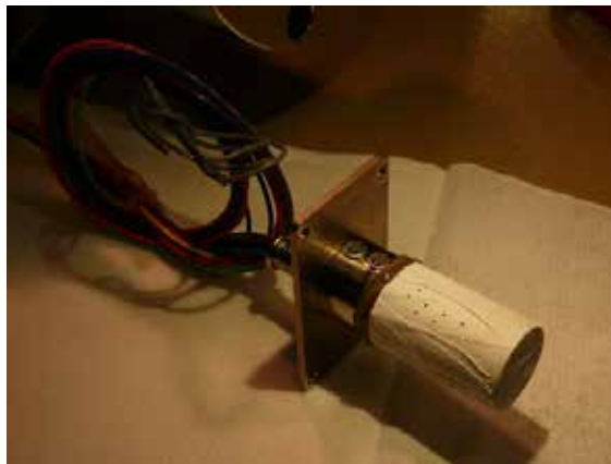
Figura 12. Sensor de Humedad Relativa Humicap.
