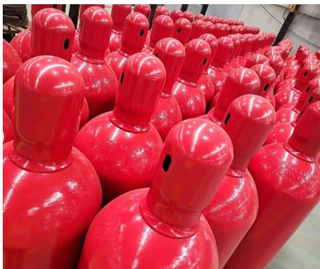
Figura 11: Bombonas de hidrógeno
