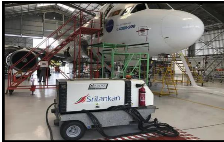
Figura 32. Generador 28V para suministrar energía eléctrica al avión. Fuente: Aero expo (2021).
