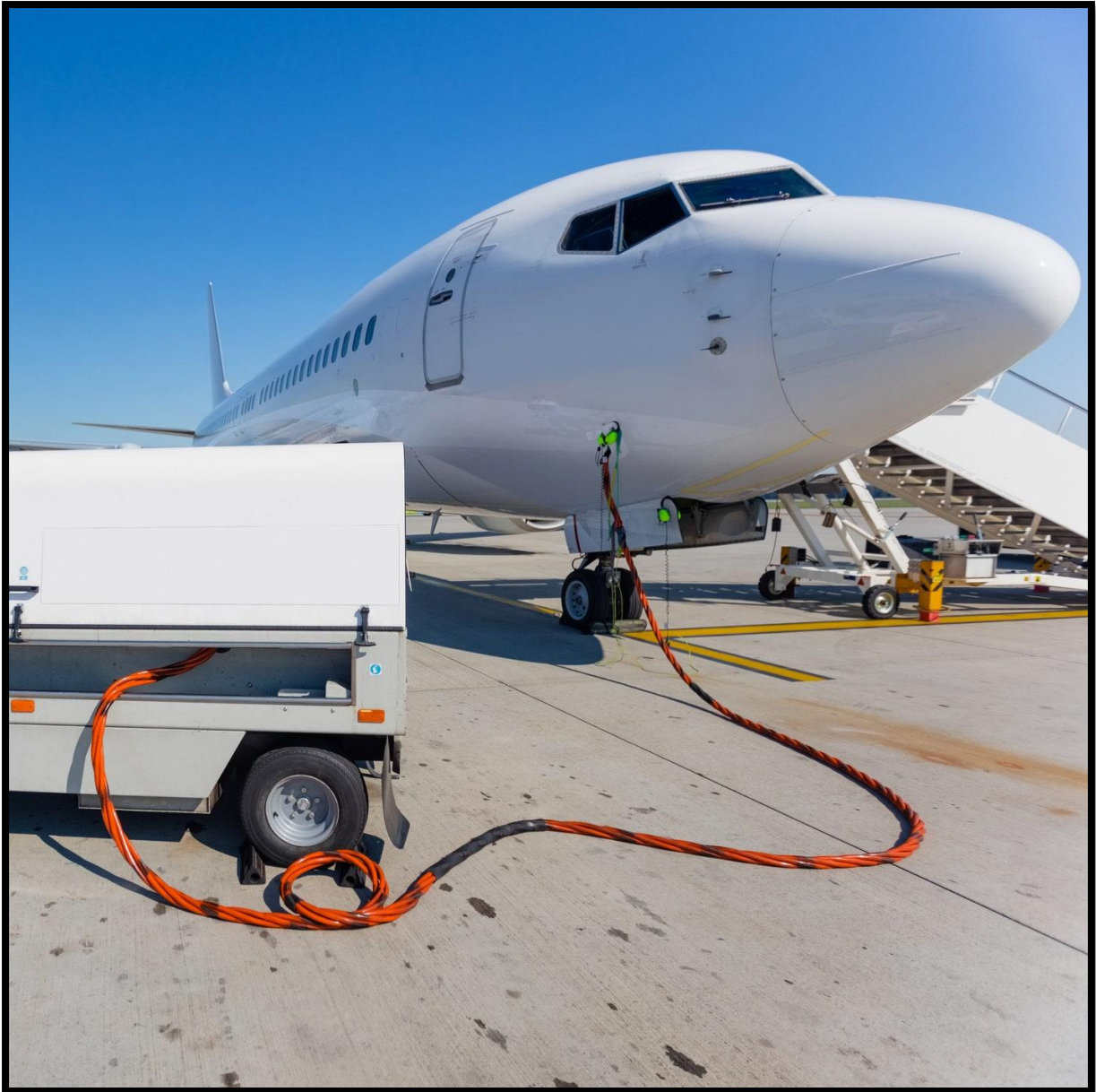
Figura 19. Unidad de apoyo en tierra (GPU). Fuente: Wired (2022).
