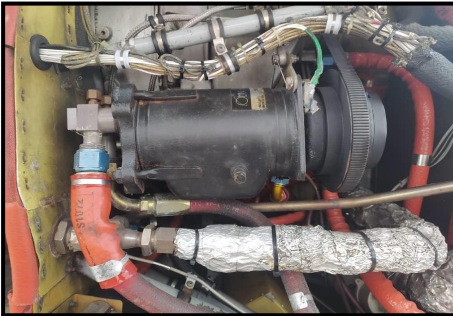
Figura 9. Compresor de aire en turbina derecha de avión King Air 200. Fuente: Arteaga, W. (2024)
