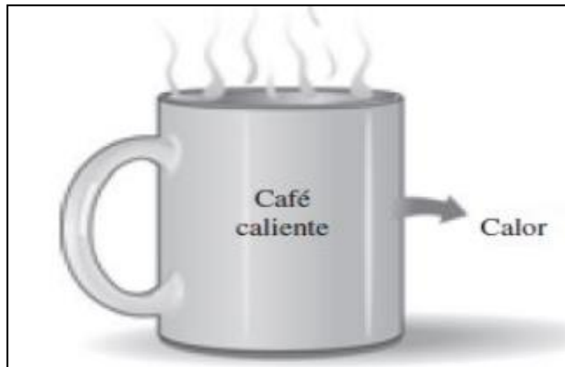
Figura 5. El calor se transfiere en sentido de lo caliente a lo frío. Fuente: Cengel, Y. (2012) termodinámica.
