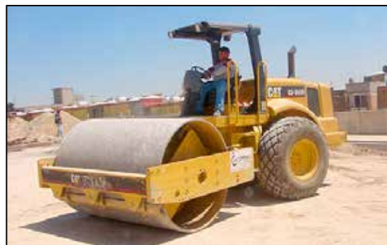
Figura 15: Equipo pesado (Vibro compactadora).
