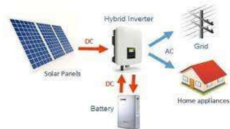
Figura 41. Sistema solar fotovoltaico, con inversor híbrido.
