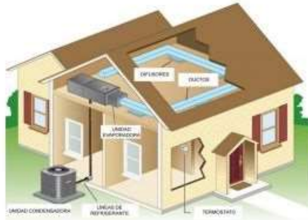
Figura 9. Aire acondicionado central
