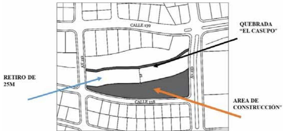
Figura 14. Plano de ubicación de área de construcción. (2017)
