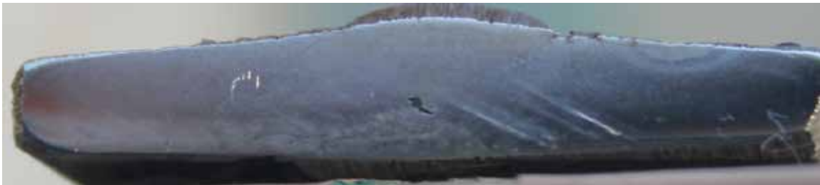
Figura 60: Probeta soldada con E-6010 a 80 Amp. Fuente: Santo G. y Fajardo J. (2.017).
