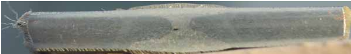
Figura 64: Probeta soldada con E-6013 a 100 Amp.
