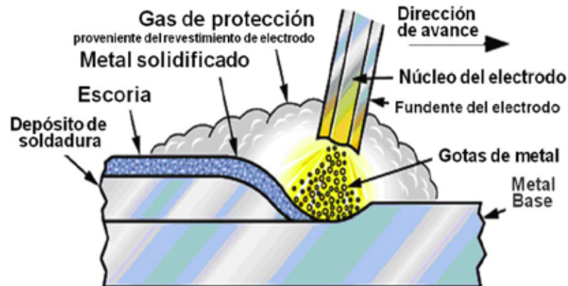
Figura 3: Soldadura por arco eléctrico. Fuente: I.E.S. "Cristóbal de Monroy". Dpto. de Tecnología
