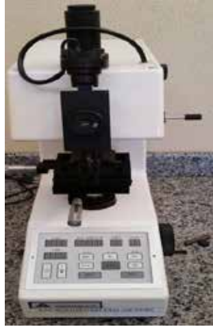
Figura 32: Micro durómetro Vickers. Fuente: Laboratorio de materiales Escuela Ingeniería Mecánica UC (2.017)
