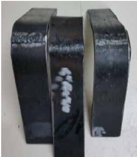
Figura 49: Doblado de la probeta soldada con electrodo E-6010 a 100Amp. Fuente: Santo G. y Fajardo J. (2017).
