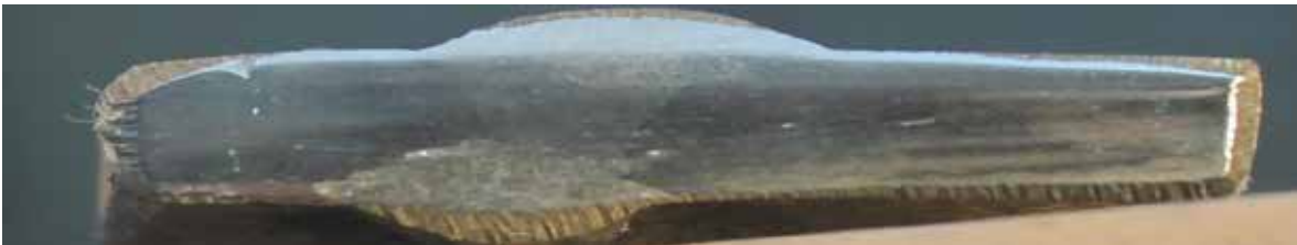
Figura 67: Probeta soldada con E-7018 a 120 Amp.
