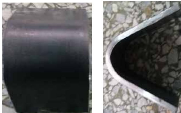
Figura 36: Doblado de la probeta sin soldar (Metal Base).
