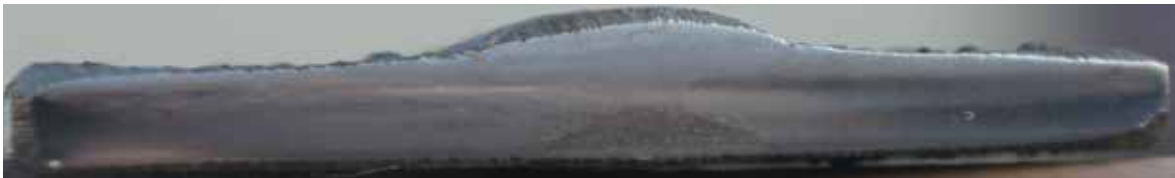
Figura 65: Probeta soldada con E-6013 a 120 Amp.
