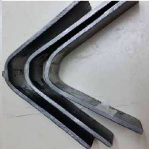
Figura 50: Doblado de la probeta soldada con electrodo E-6010 a 120Amp. Fuente: Santo G. y Fajardo J. (2017).
