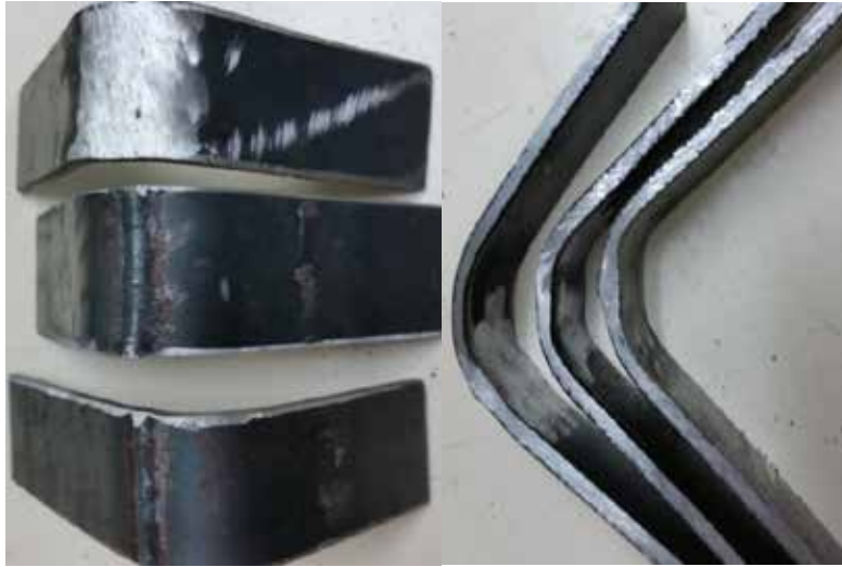
Figura 55: Doblado de la probeta soldada con electrodo E-7018 a 120Amp. Fuente: Santo G. y Fajardo J. (2017).
