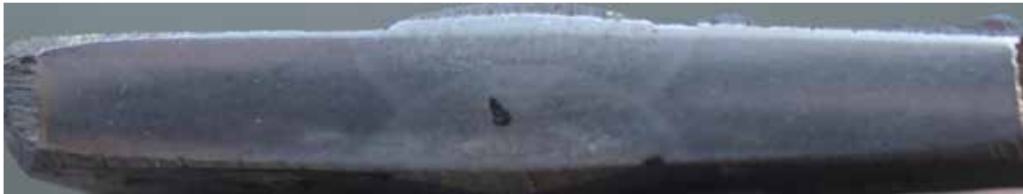
Figura 63: Probeta soldada con E-6013 a 80 Amp.
