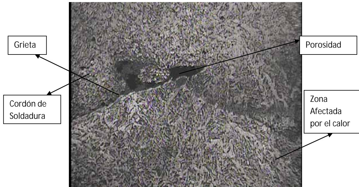
Figura 70: Microestructura de la probeta soldada con electrodo E-6010 a 100Amp Fuente: Santo G. y Fajardo J. (2.017)
