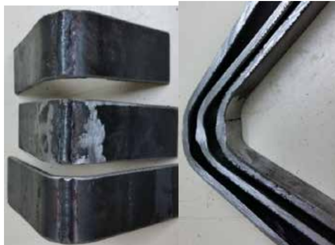
Figura 54: Doblado de la probeta soldada con electrodo E-7018 a 90Amp. Fuente: Santo G. y Fajardo J. (2017).
