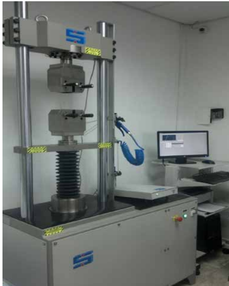
Figura 19: Máquina para el Ensayo de Tracción Fuente: Laboratorio Trexa, C.A. (2017)
