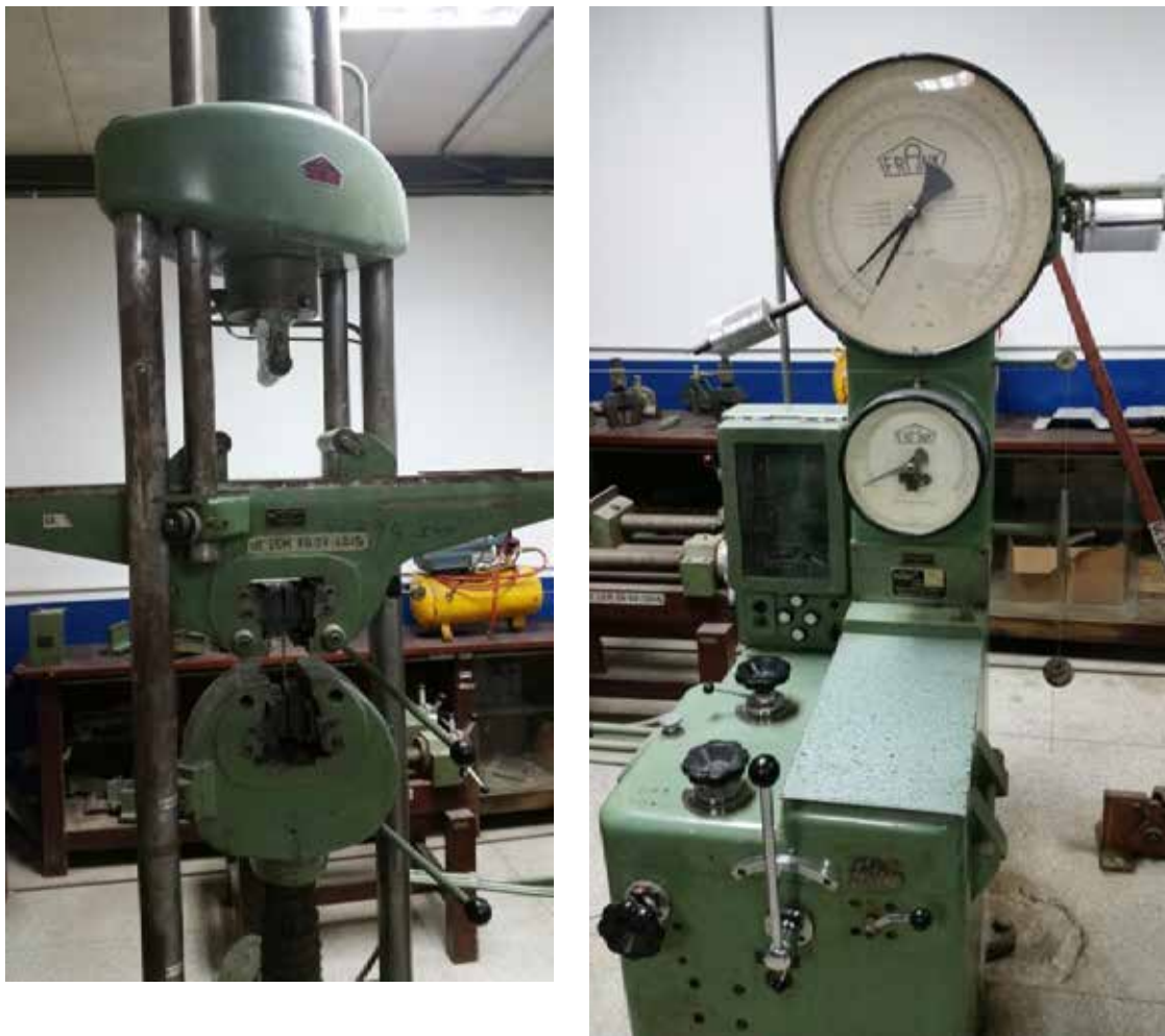
Figura 37: Máquina para ensayo de tracción FRANK. Fuente: Laboratorio de Materiales Universidad de Carabobo (2.017)
