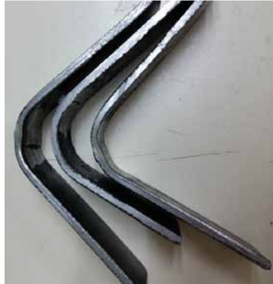
Figura 49: Doblado de la probeta soldada con electrodo E-6010 a 100Amp. Fuente: Santo G. y Fajardo J. (2017).
