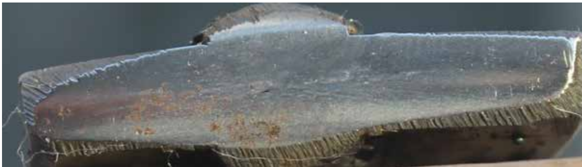
Figura 61: Probeta soldada con E-6010 a 100 Amp. Fuente: Santo G. y Fajardo J. (2.017).
