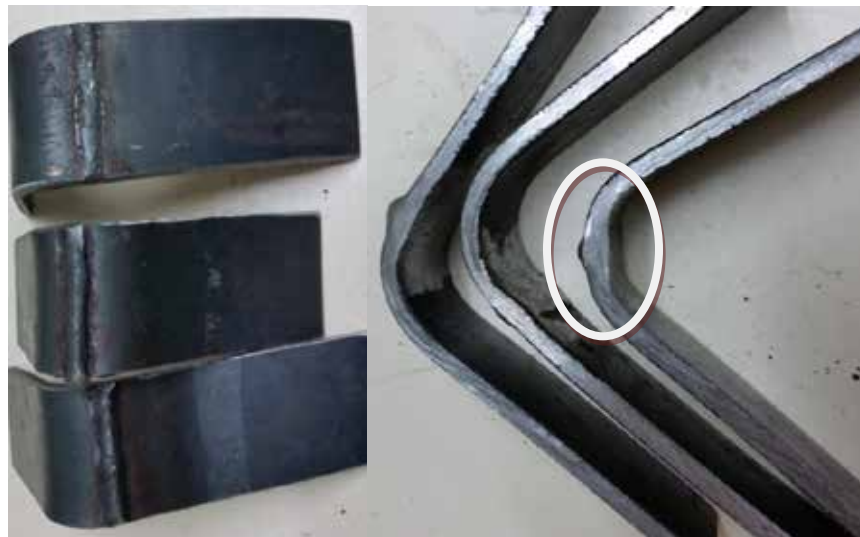
Figura 56: Doblado de la probeta soldada con electrodo E-7018 a 150Amp. Fuente: Santo G. y Fajardo J. (2017).
