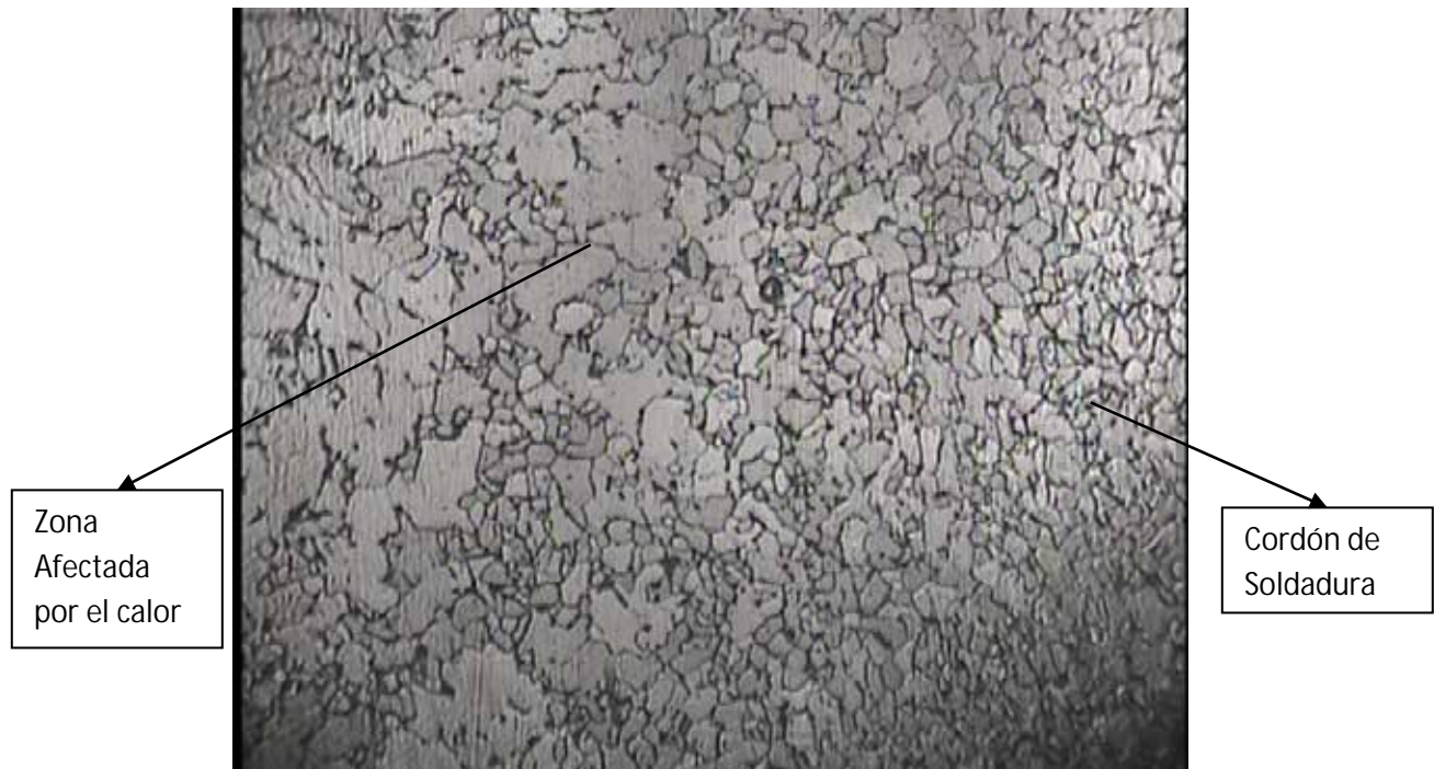
Figura 72: Microestructura de la probeta soldada con electrodo E-6013 a 80Amp. Fuente: Santo G. y Fajardo J. (2.017)
