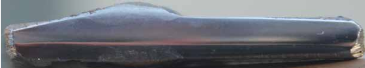
Figura 66: Probeta soldada con E-7018 a 90 Amp.
