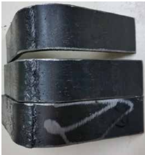
Figura 50: Doblado de la probeta soldada con electrodo E-6010 a 120Amp. Fuente: Santo G. y Fajardo J. (2017).
