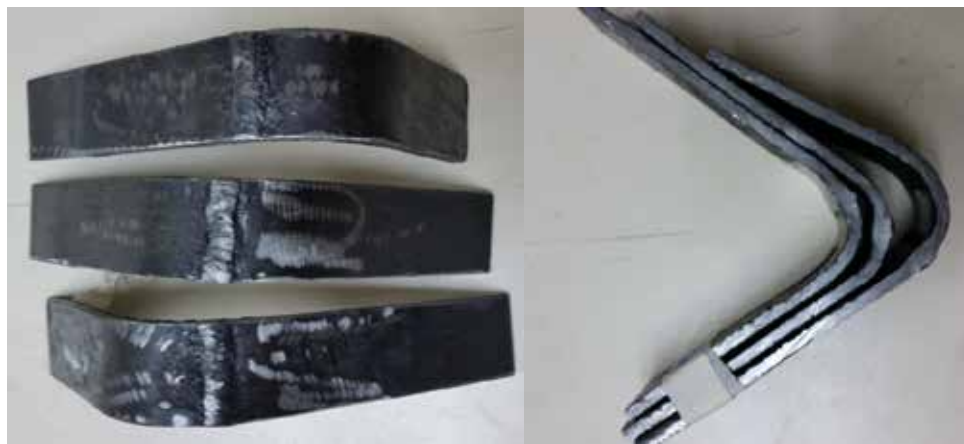
Figura 48: Doblado de la probeta soldada con electrodo E-6010 a 80Amp.
