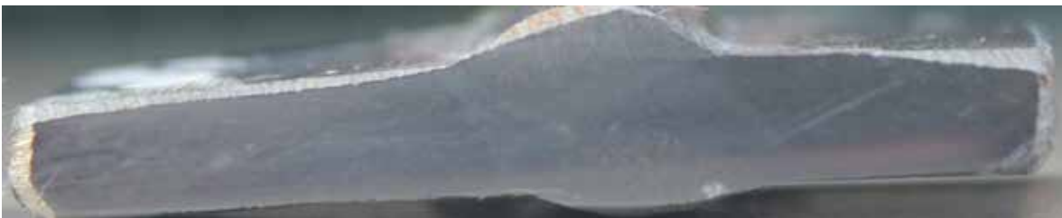
Figura 68: Probeta soldada con E-7018 a 150 Amp.
