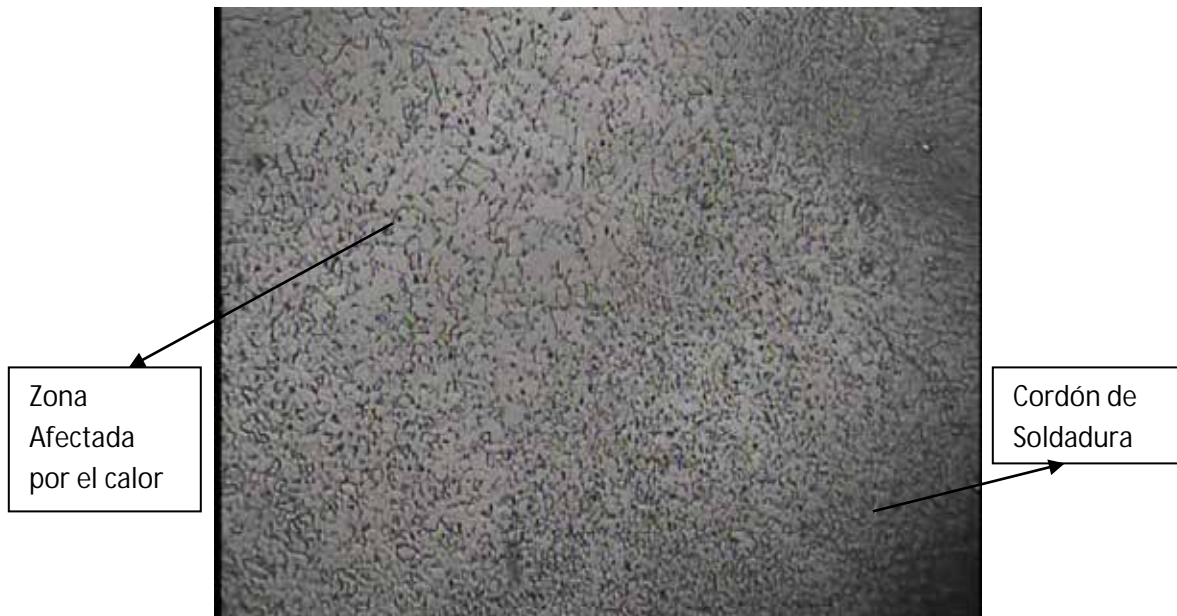
Figura 71: Microestructura de la probeta soldada con electrodo E-6010 a 120Amp. Fuente: Santo G. y Fajardo J. (2.017)
