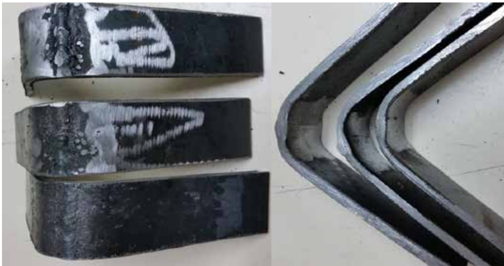
Figura 52: Doblado de la probeta soldada con electrodo E- 6013 a 100Amp. Fuente: Santo G. y Fajardo J. (2017).
