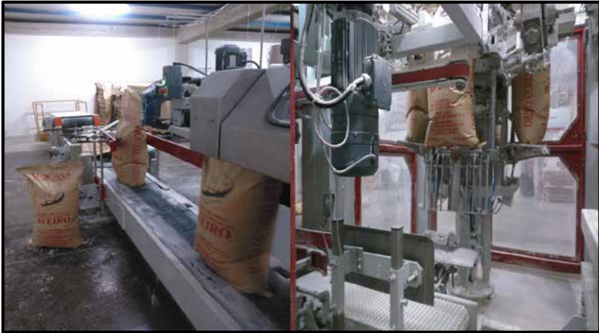
Figura N° 4. Proceso productivo de la línea tres (E-905) del área de empaque de harina de la empresa Molinos Carabobo, S.A.
