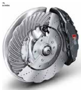
Figura 90. Discos de freno ondulados.
