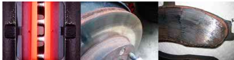
Figura 19. Recalentamiento y desvanecimiento del disco y las pastillas.
