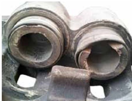
Figura 54 Vista de una pinza de freno con los émbolos dañados.
