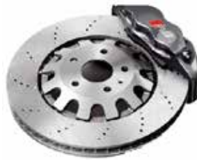
Figura 9. Disco de freno perforado o flotante.
