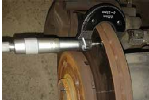
Figura 46. Medición del grosor del disco mediante micrómetro.
