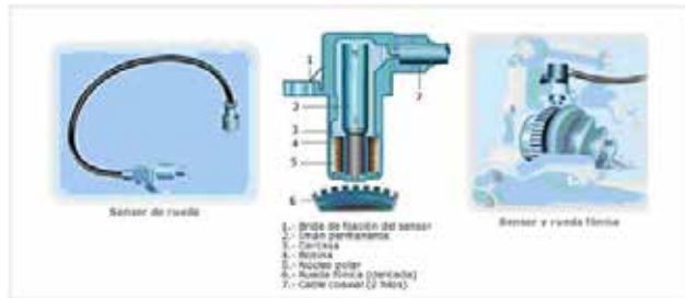
Figura 68. Colocación del sensor de rueda. Fuente: Venegas W. (2012).
