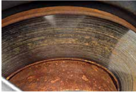
Figura 44. Vista de un disco de freno oxidado.
