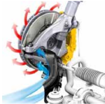
Figura 7. Ventilación dinámica de disco de frenos.
