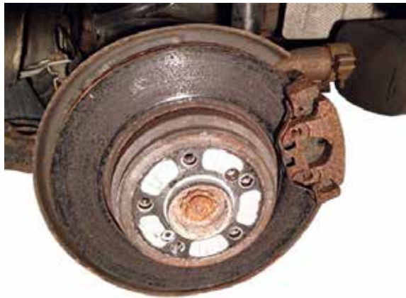
Figura 39. Vista de un disco de freno oxidado por un largo periodo de tiempo con el vehículo estacionado.
