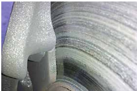
Figura 43. Vista de un disco con la superficie de fricción rayada.
