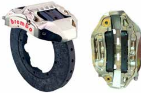
Figura 12. Disco de freno fabricado en carbono y pastillas de freno específicas. Fuente: Kashima University (2019).
