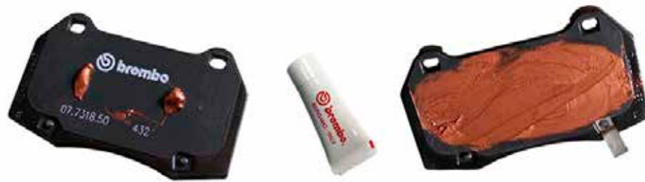
Figura 37. Lubricación de la base de las pastillas con pasta de cobre especial alta temperatura.
