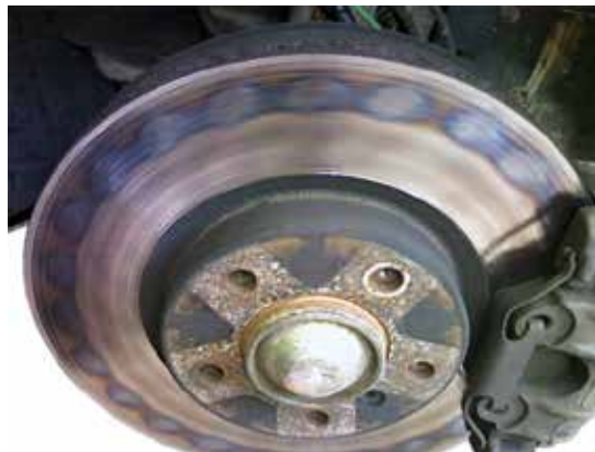
Figura 40. Vista de un disco de freno con puntos de calor (deformación térmica) provocados por sobrecalentamiento.
