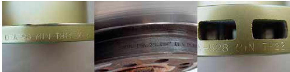
Figura 47. Espesor mínimo troquelado en algunos discos de freno.
