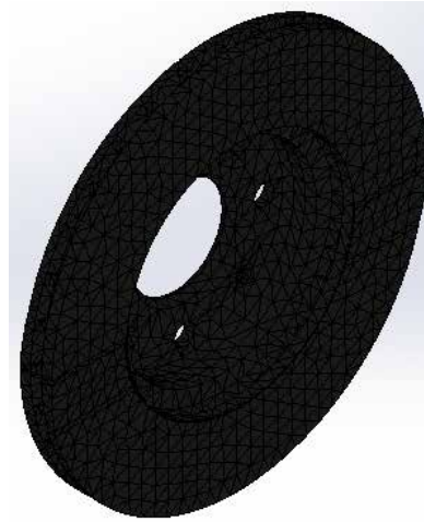
Figura 105. Apariencia del mallado para el análisis de frecuencia.
