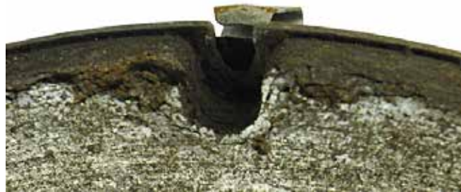
Figura 53. Pastilla con desprendimiento de ferodo.
