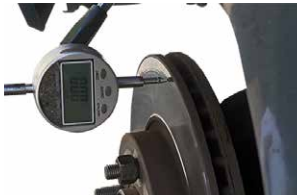
Figura 48. Medición del alabeo de un disco de freno.
