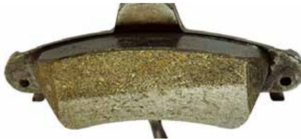
Figura 52. Pastilla con desgaste irregular. Fuente: Kashima University (2019)
