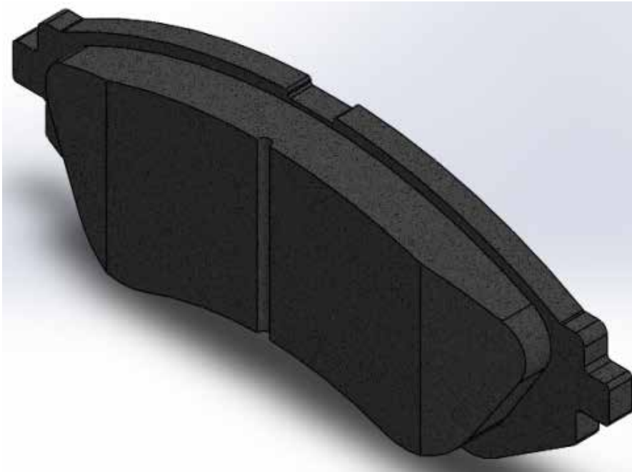
Figura 93. Modelo 3D de la pastilla.
