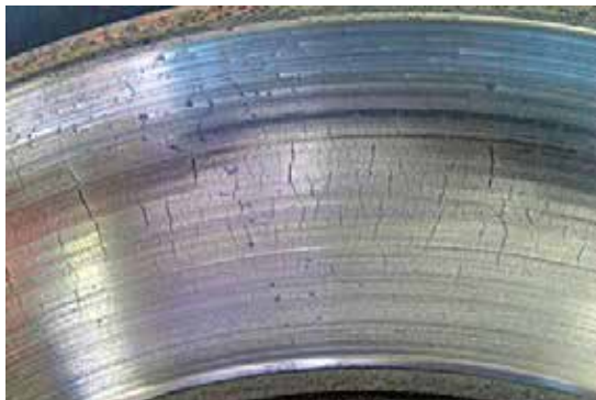
Figura 42. Vista de un disco con la superficie de fricción agrietada.
