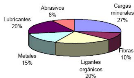
Figura 17. Composición porcentual de los materiales de fricción.
