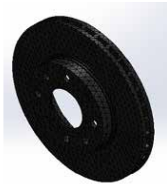
Figura 98. Apariencia del mallado para el análisis térmico.
