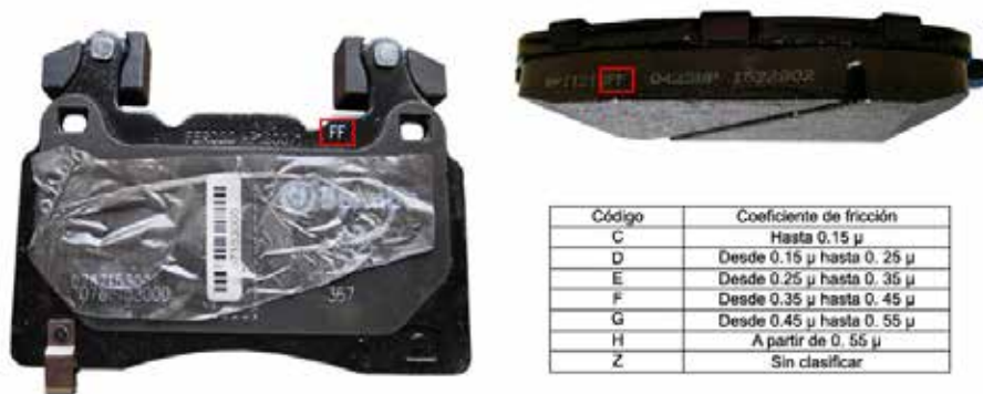
Figura 16. Clasificación de los coeficientes de fricción y su codificación en una pastilla de freno.
