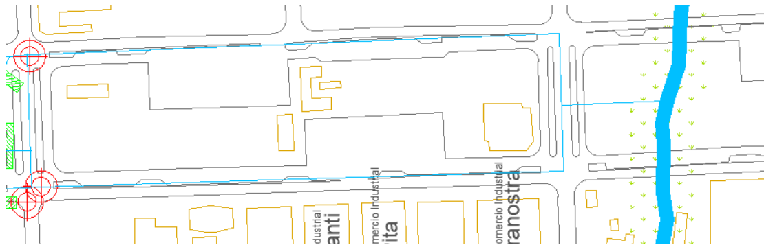
Figura 88: Sistema de drenajes del sector de estudio desembocadura al caño Quigua.
