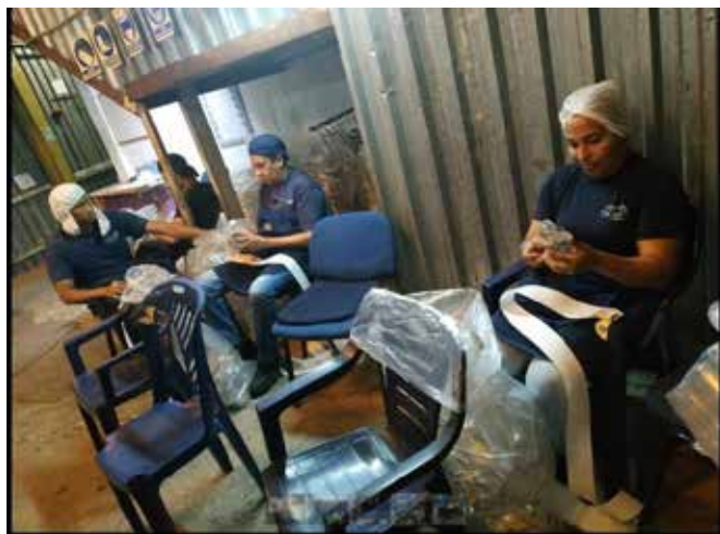
Figura 3. Proceso de etiquetado de los envases de forma manual. Autores: González, J. y Moreno, S. (2019).
