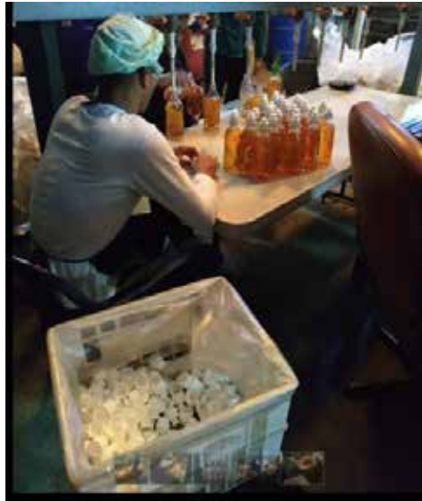
Figura 6. Proceso de tapado y enroscado de envases de forma manual. Autores: González, J. y Moreno, S. (2019).
