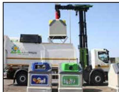
Figura 88: Camión recolector de desechos con grúa móvil con movimiento restringido Fuente: gestoresderesiduos (2017)
