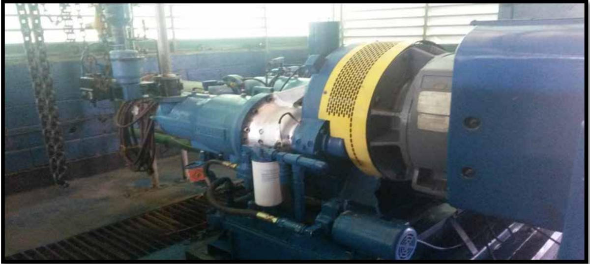
Figura 32. Compresor N o 3 Ingersoll – Rand, modelo Centac – C26
