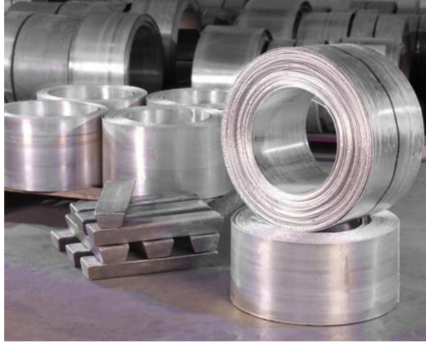
Figura 17 Lingotes y bobinas de láminas de magnesio con un espesor de solo 3 mm
