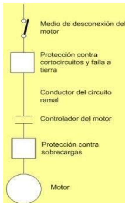
Figura 21. Diagrama de un circuito ramal de motores
