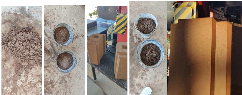
Figura 12: Comparación de humedad en las muestras, bloques hidratados y deshidratados
