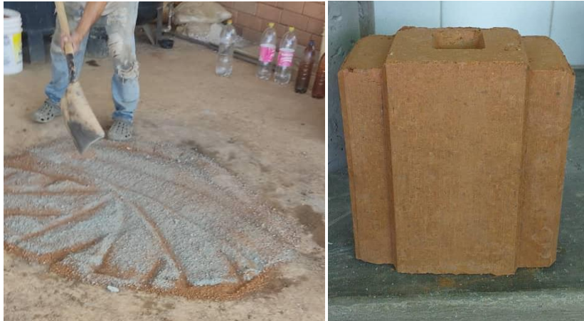
Figura 13: mezcla variación de concreto, bloque final, 15% de agua constante
