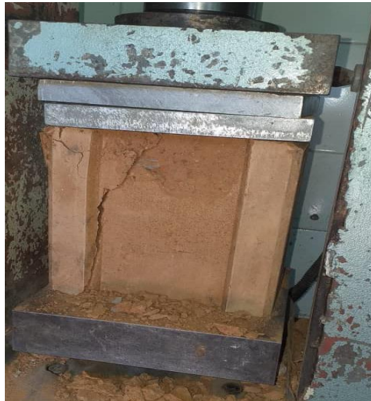
Figura 15: Ensayo a la compresión de ECOBLOCK, rotura a la máxima tensión.
