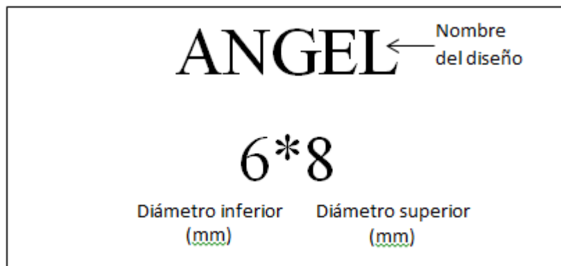
Figura 19. Identificación de los moldes de fabricación de joyas de la empresa MAGNORO C.A Fuente: Jiménez Cristiam (2017)
