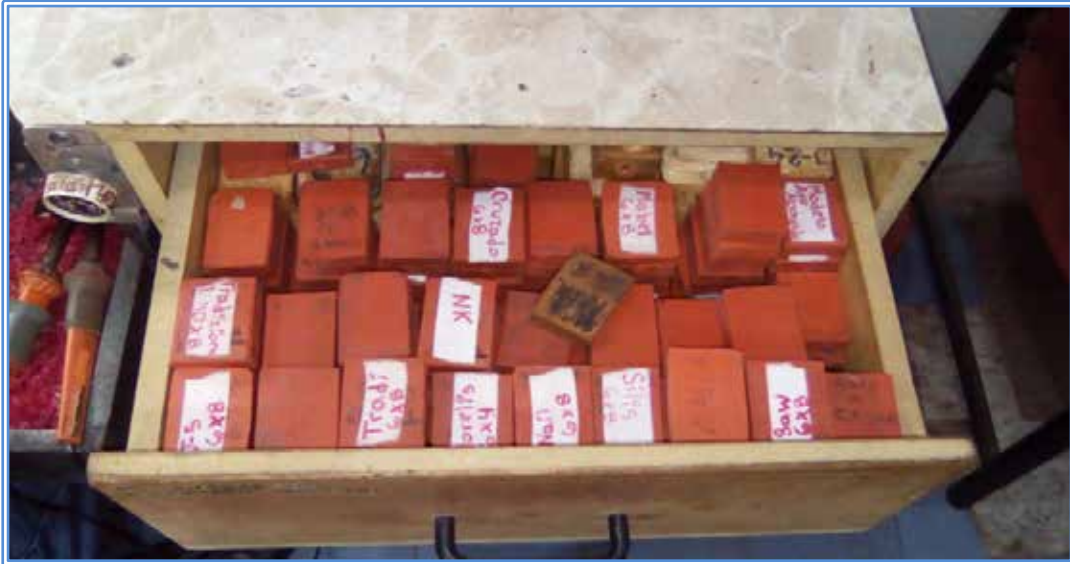
Figura 5. Moldes para inyectar cera como parte de la fabricación de joyas de la empresa MAGNORO C.A
