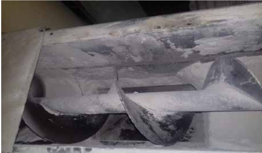
Figura 2. Transportador de canoa o sin fin equipo para todo tipo de materia prima pero de recorridos cortos.
