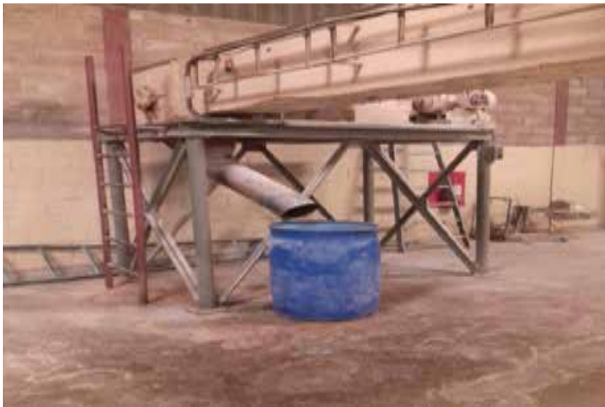
Figura 17. Zona 3, Sistema de retroalimentación del Transportador 78, Donde se deposita el reproceso que deja la operaciones de transferencia, recepción y despacho de materia prima., ubicada en el piso 6
