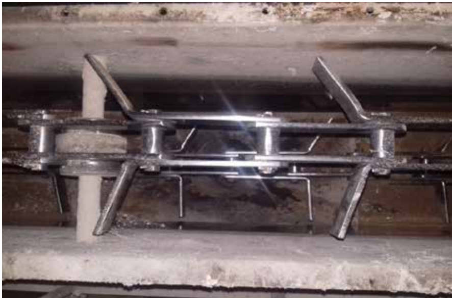
Figura 3. Transportador de arrastre de cadena para cereales de recorridos largos.
