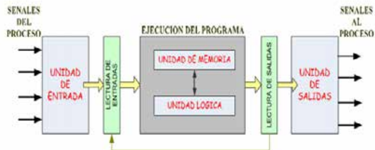
Figura 6. Unidades funcionales del PLC
