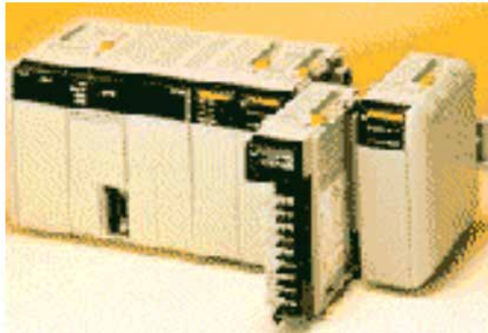
Figura 9. PLC tipo Modular. Fuente: Programación del PLC pág. 103.
