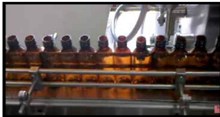
Figura 11. Cinta Transportadora de Entrada para el carrusel.
