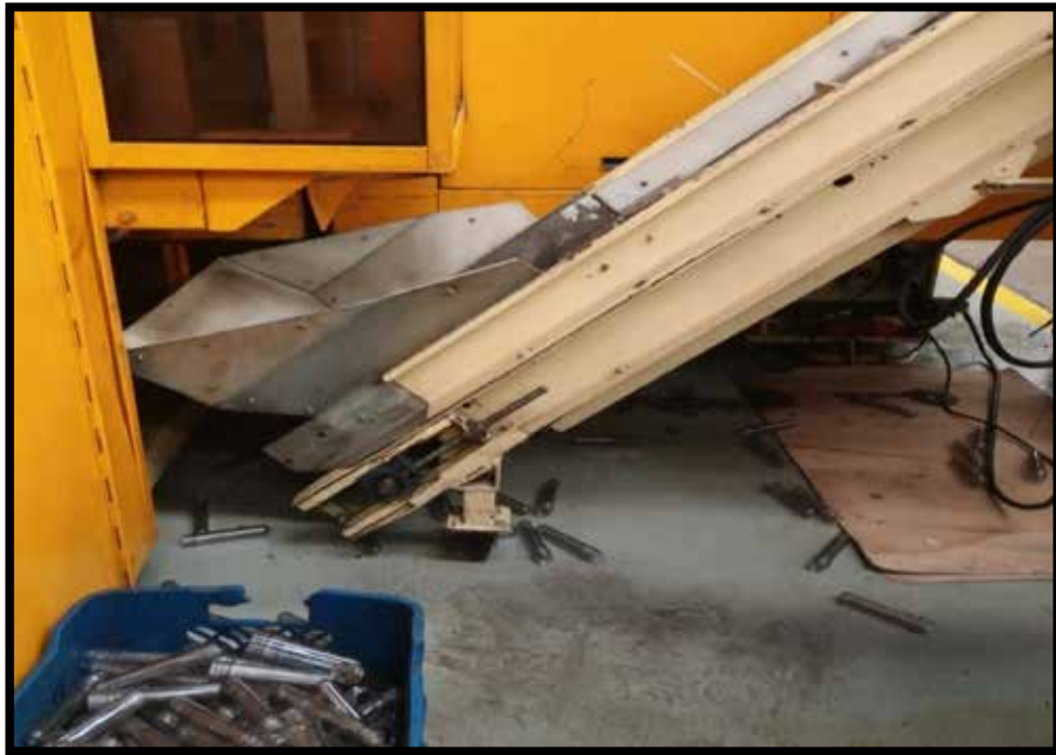
Figura 15. Scrap por falla de conveyor.
