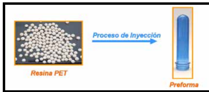
Figura N° 2. Proceso de inyección Tomado del Departamento de Operaciones de Amcor Rigid Plastics de Venezuela, S.A.
