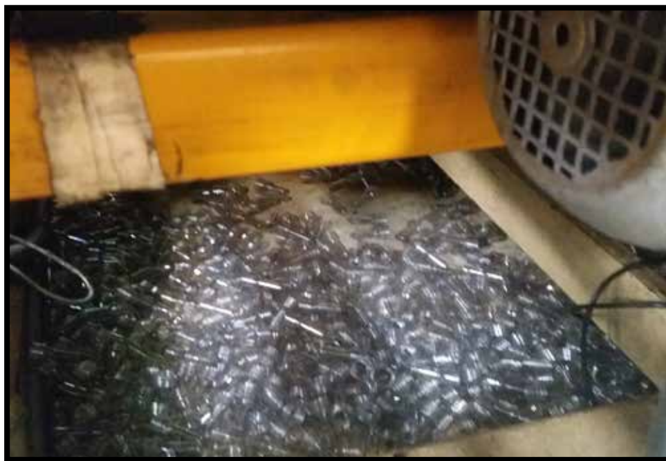
Figura 16. Preformas en el suelo por falla de conveyor.
