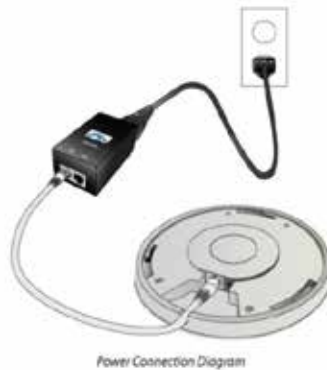
Figura 28. Conexión Antena Ubiquiti.
