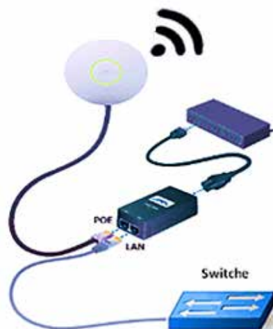
Figura 31. Conexión Antena Ubiquiti con switch
