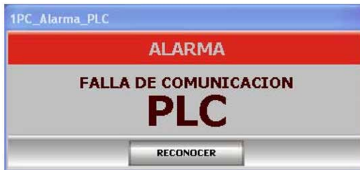
Figura 51. Alarma de falla de comunicación
