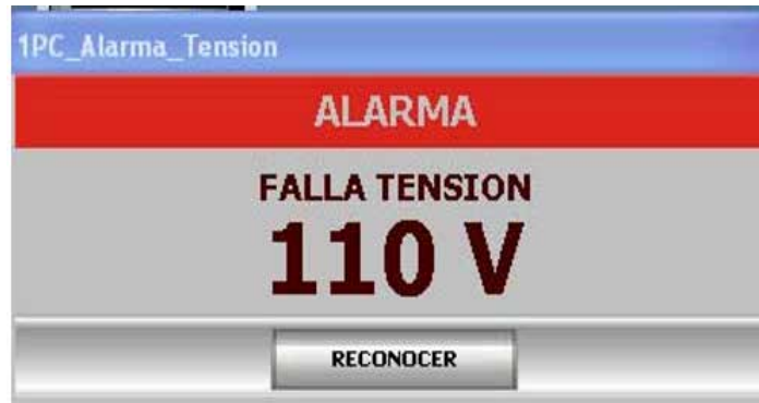
Figura 50. Alarma de falla de potencia
