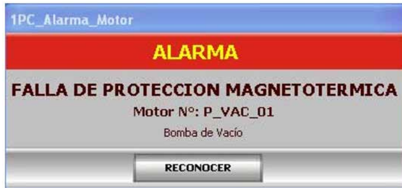
Figura 56. Alarma de disparo magnetotérmico
