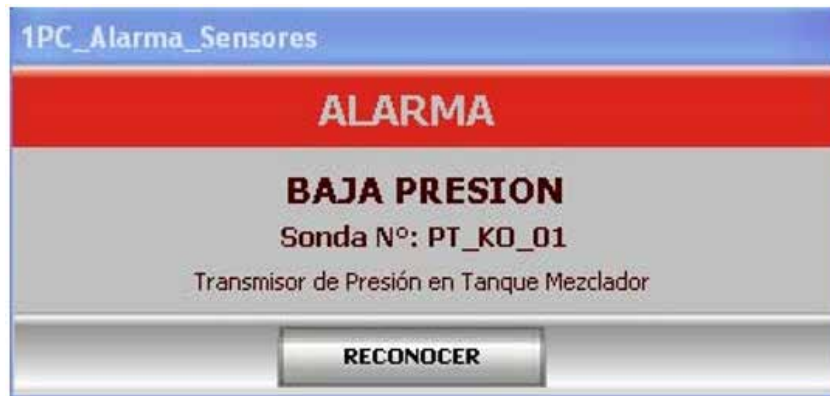
Figura 54. Alarma de baja presión
