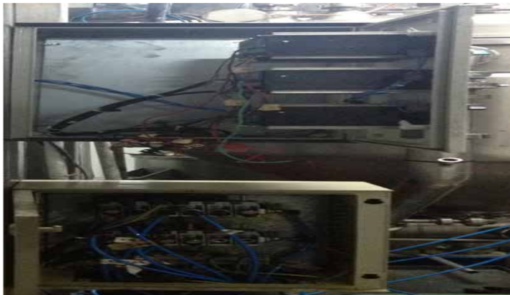
Figura 11. Vista lateral interna de los tableros de las balanzas digitales y cuerpo de electroválvulas del Koruma
