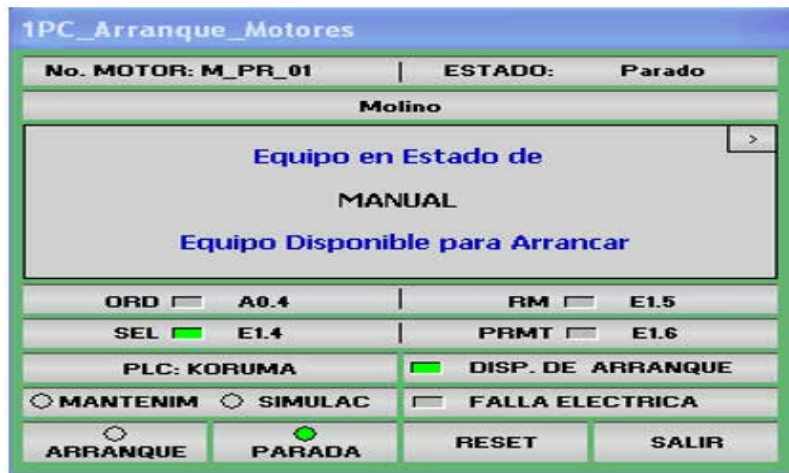
Figura 59. Ventana de arranque y parada en modo manual de motores Fuente: Richard Quijada
