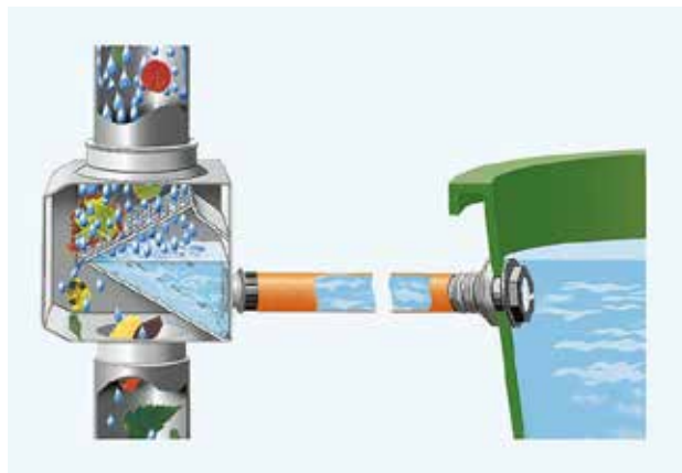
Figura 48. Filtro aguas de lluvia. Google (2017).
