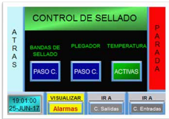
Figura 44. Control de sellado.
