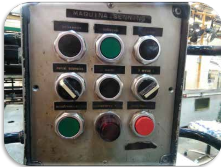
Figura 7. Imagen de Pulsadores para el funcionamiento de la envolvente de servilletas Z grande Fuente: Elaboración Propia (2017)
