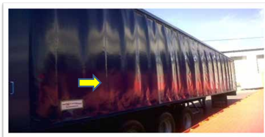
Figura 6. Vulcanización de ruedos correspondientes. Fuente: Empresa Pexmark, C.A
