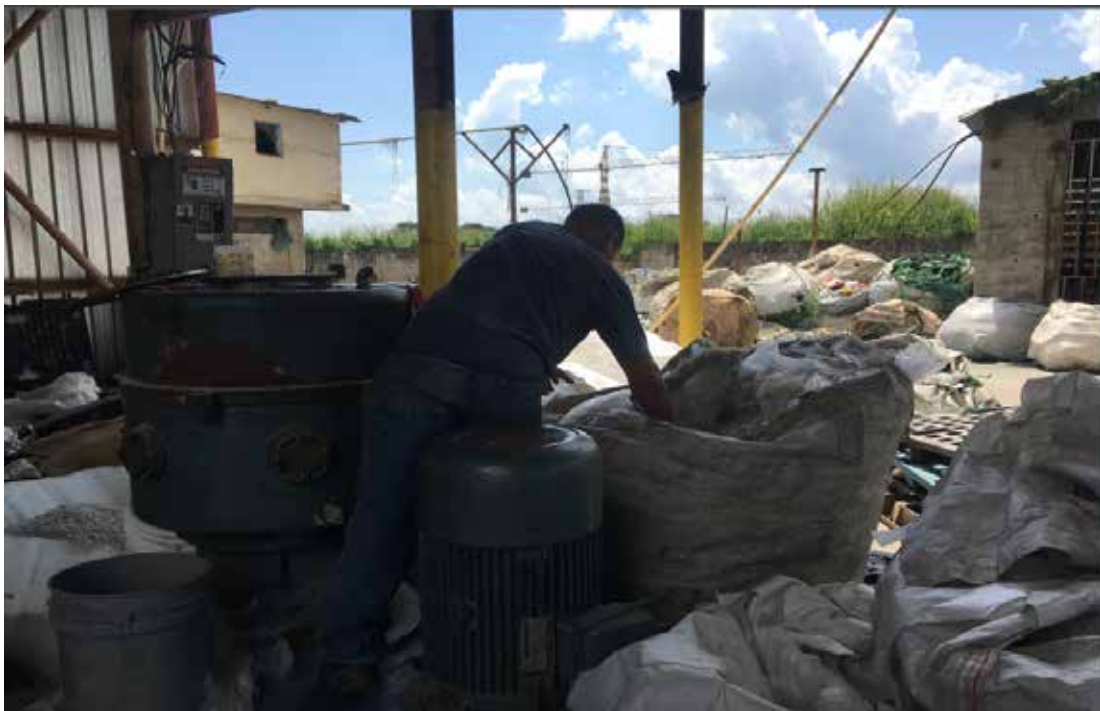
Figura 4 Proceso de vaciado de las sacas a la máquina de cotufado. Fuente: Ramos, A. (2017)
