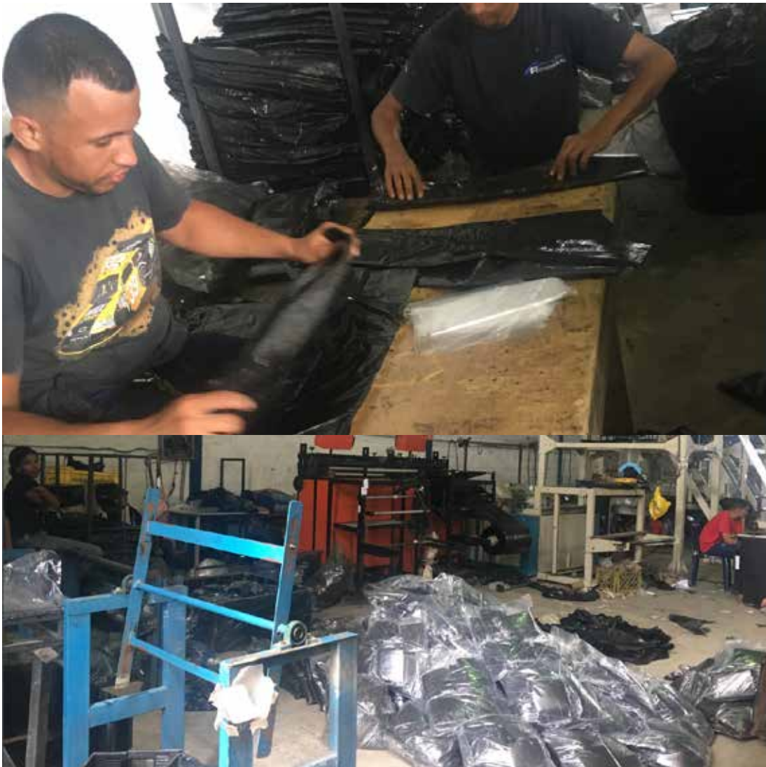
Figura 12. Proceso de embalaje de las bolsas de plástico en la presentación de un 1 kg. Fuente: Ramos, A. (2017)
