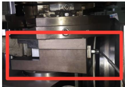
Figura 22: Medidor de esfuerzos cortantes para los punzones inferiores. Fuente: Liseth-Nieto (2.021)
