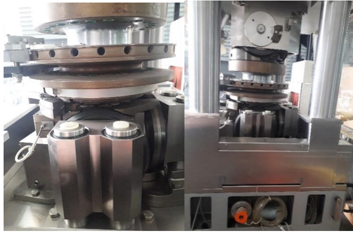
Figura 19: Estación de presión previa o precompresión. Fuente: Liseth-Nieto (2.021)
