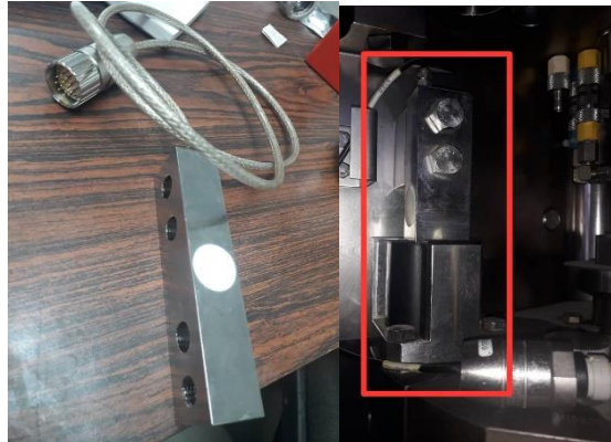
Figura 21: Medidor de esfuerzos cortantes para los punzones superiores Fuente: Liseth-Nieto (2.021)
