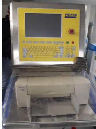
Figura 10: Consola de mando de la Fette P1200. Fuente: Liseth-Nieto (2.021)
