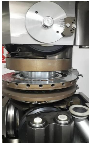
Figura 20: Estación de presión principal Fuente: Liseth-Nieto (2.021)
