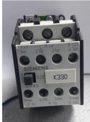
Figura 31: Relevador K330 con contactos auxiliares. Fuente: Liseth-Nieto (2.021)
