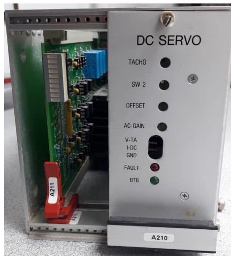
Figura 16: Driver que controla los tres servomotores. Fuente: Liseth-Nieto (2.021)
