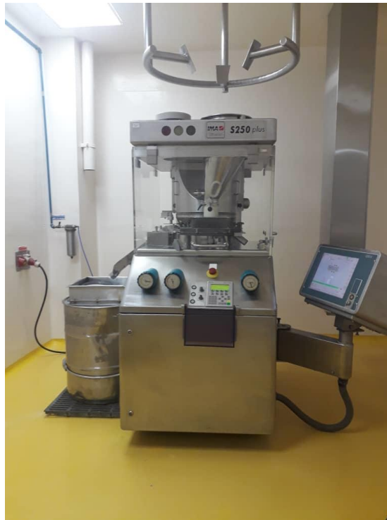
Figura 24: Tableteadora Kilian S250 Plus en el área de Sólidos de Calox
