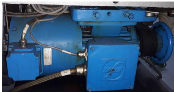
Figura 12: Motor principal de la Fette P1200. Fuente: Liseth-Nieto (2.021)
