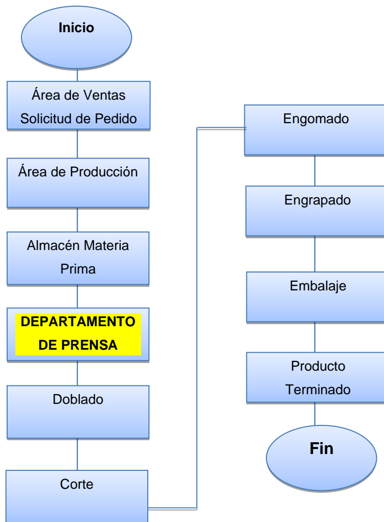
Figura 1. Diagrama de Bloques del Proceso Productivo de Ediciones Delforn, C.A. Fuente: Información suministrada por la empresa Ediciones Delforn, C.A. (2014).
