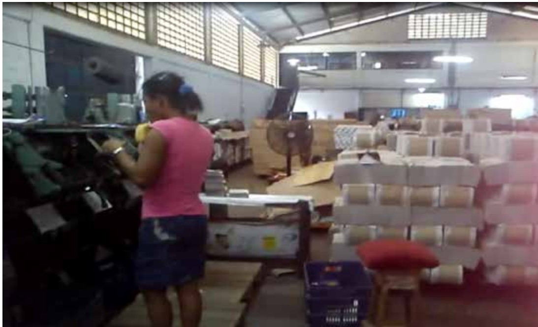
Figura 12. Falta de Dotación de los Equipos de Seguridad Personal.
