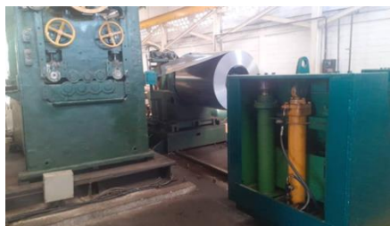
Figura N°4. Ilustración del proceso de producción en la línea de corte y planchado.
