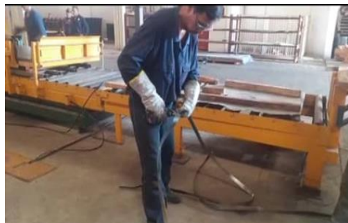
Imagen 8. Cortando el Fleje a la Media Establecida.
