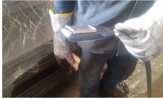
Imagen 9. Colocación de Grapa en el Fleje.
