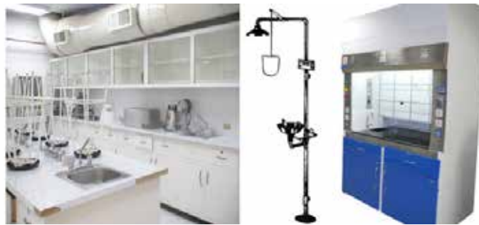
Figura 40. Laboratorio, ducha de emergencia con lavaojos y campana de gases.(2018).
