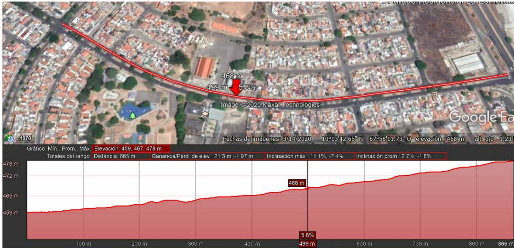
Figura 22: Plano de perfil longitudinal, Av. Circunvalación Sur.
