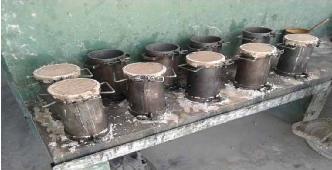
Figura 15. Toma de cilindros o probetas
