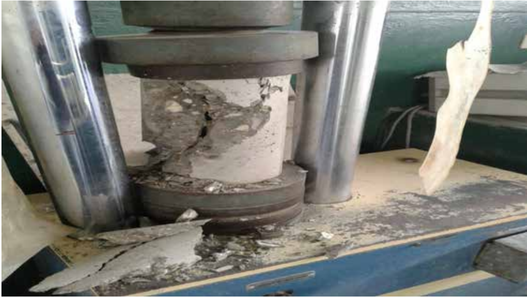
Figura 24. Ruptura a la compresión de probetas
