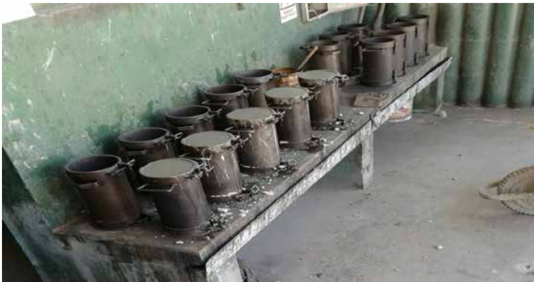
Figura 16. Toma de cilindros o probetas
