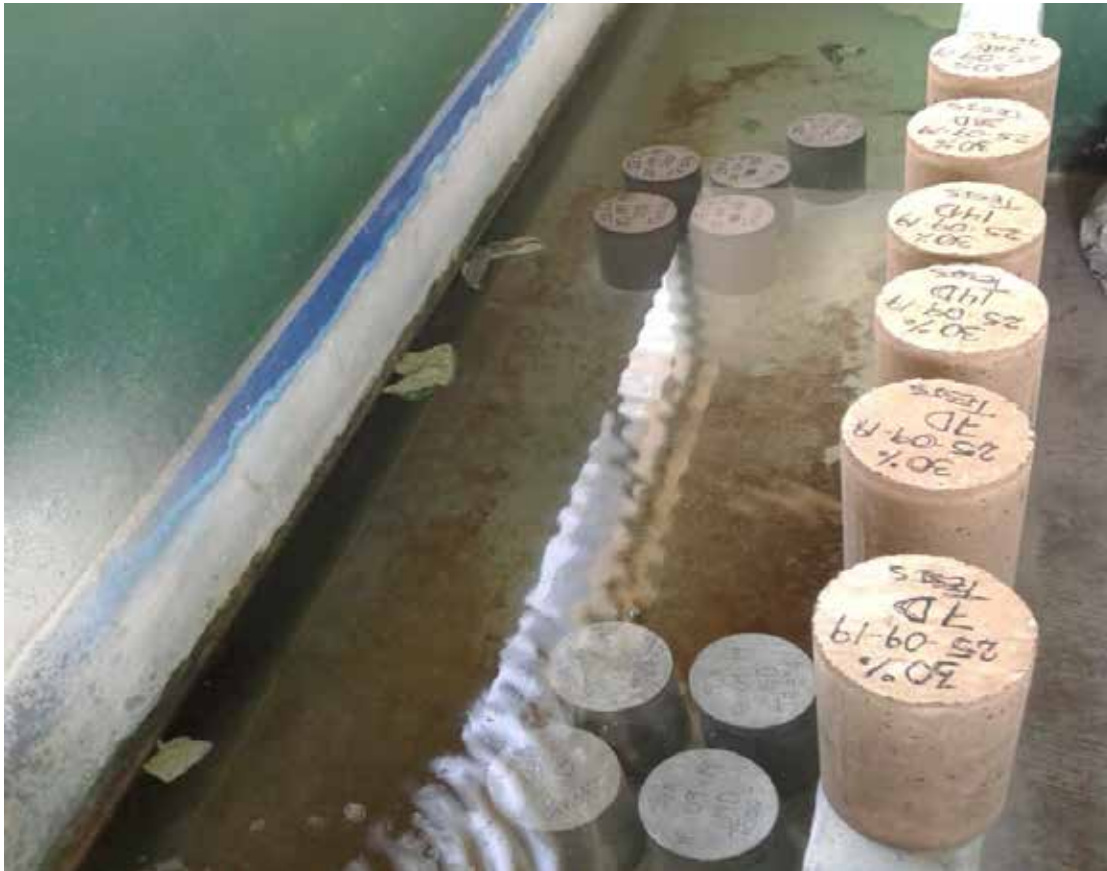
Figura 21. Preparación de las probetas para la ruptura
