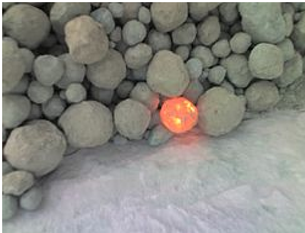
Figura 1. Clinker de cemento antes de su molienda
