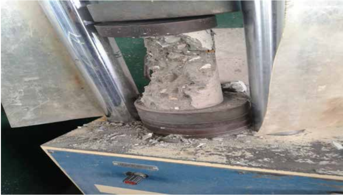
Figura 26. Ruptura a la compresión de probetas
