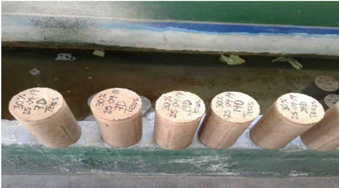
Figura 20. Curado de probetas
