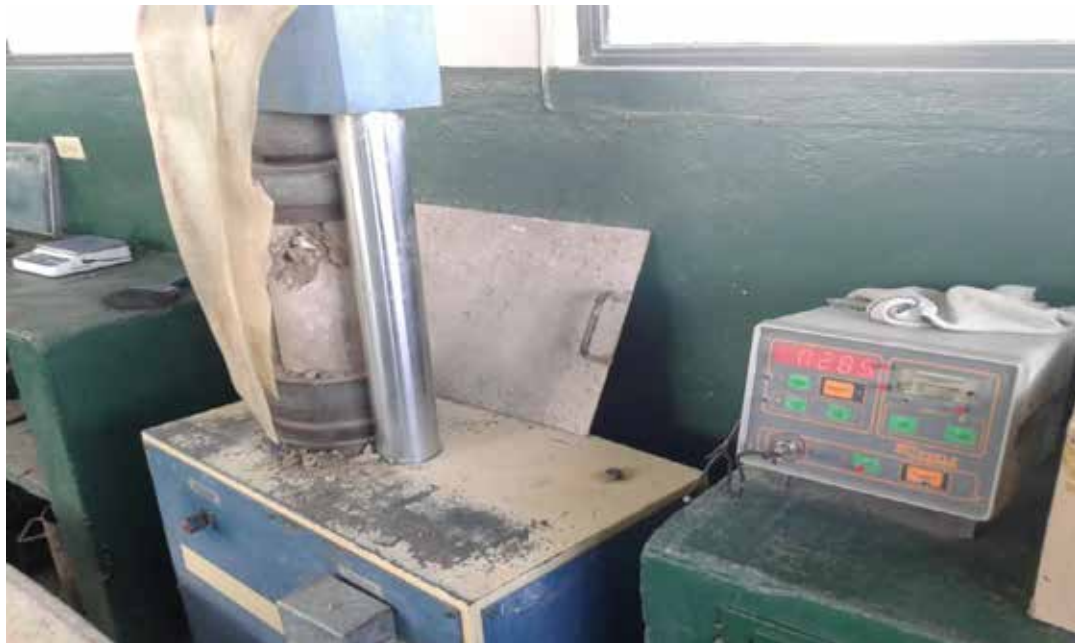
Figura 25. Ruptura a la compresión de probetas
