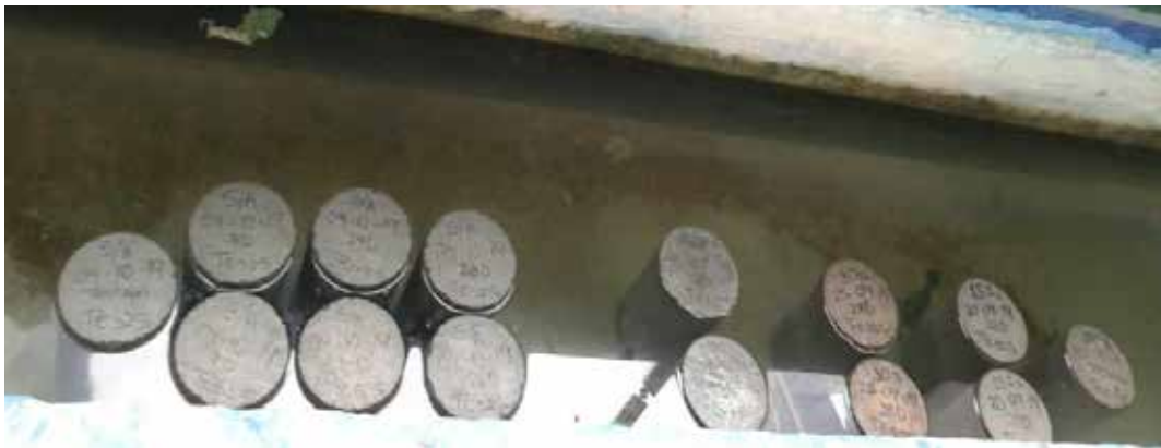
Figura 18. Curado de probetas
