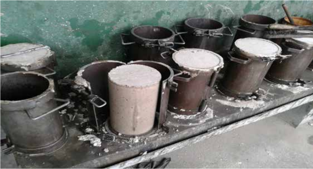
Figura 17. Desencofrado de moldes
