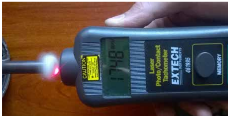
Figura 32. Medición Velocidad Baja del Motor.
