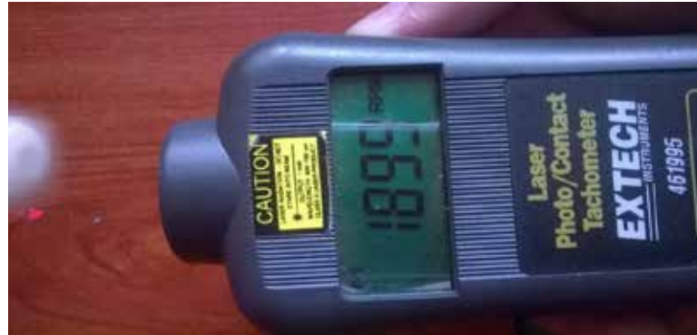
Figura 33. Medición Velocidad Media del Motor.
