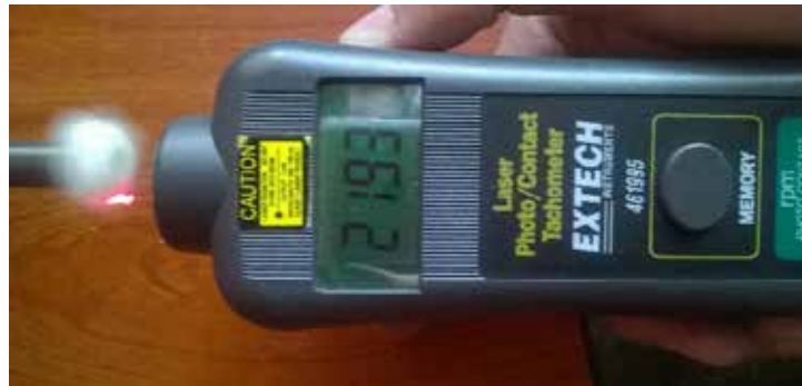
Figura 34. Medición Velocidad Alta del Motor.
