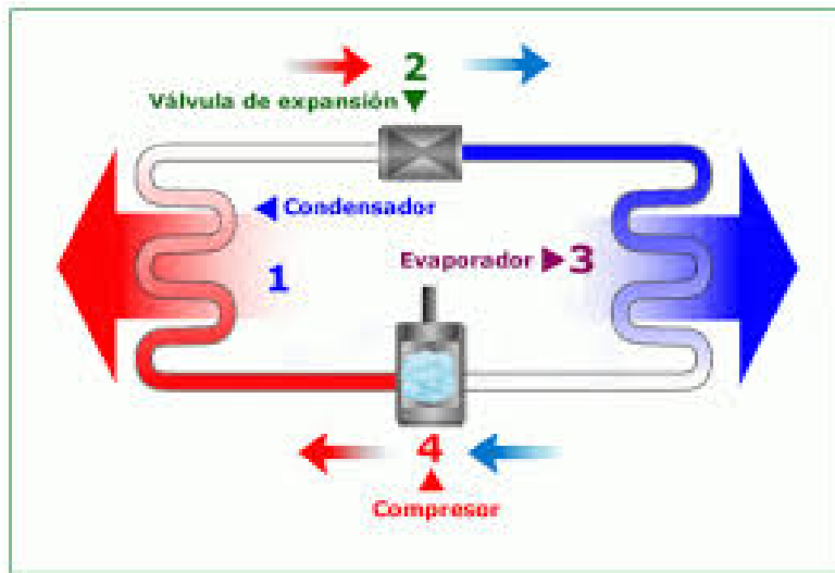
Figura 3. Ciclo de refrigeración básico
