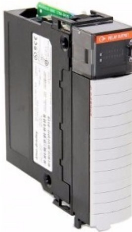
Figura 17. Módulo de salida digital.
