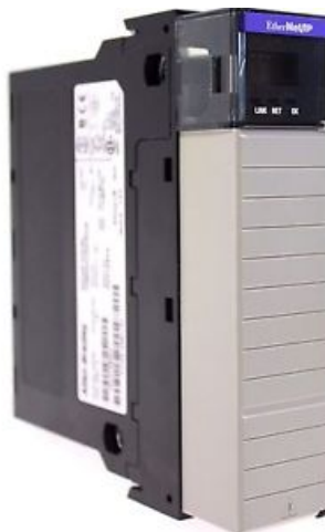
Figura 20. Módulo de comunicaciones ETHERNET.
