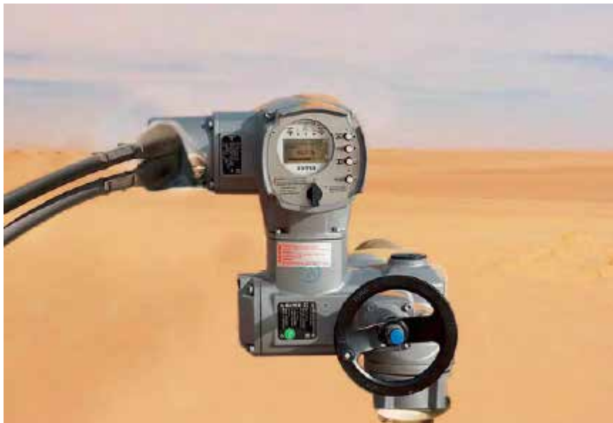
Figura 10. Actuador eléctrico tipo multivuelta AUMA.
