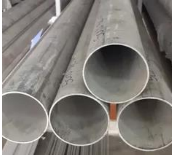
Figura 28. Tubería de acero inoxidable de 4 pulgadas
