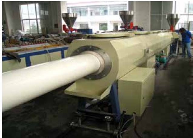
Figura 4. Tanque de Enfriamiento.
