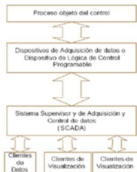
Figura 9. Sistema Estructural de un Scada
