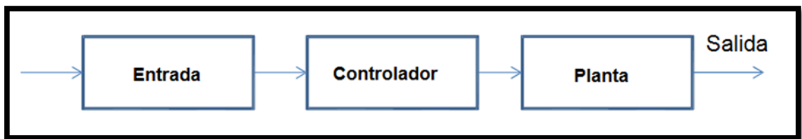
Figura 4. Sistema de Control a Lazo Abierto.
