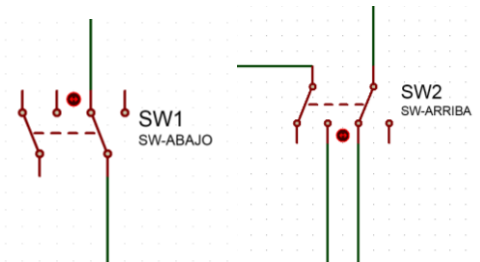
Figura 33: Estado de los Microswitchs en Nivel Superior.
