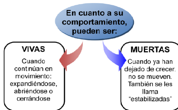
Figura 4: clasificación de las fisuras
