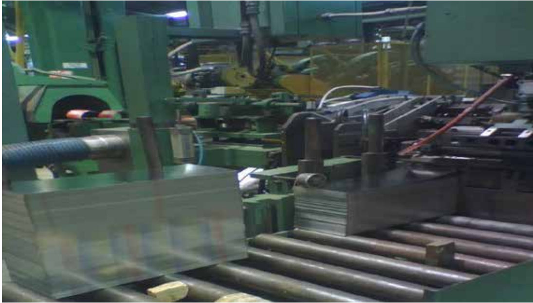
Figura 9 Prensa formadora del envase Standum “Bodymaker”, Fuente: Tomado del Departamento de Producción de la empresa Prodevases Crown, S.A. (2017).
